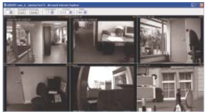
Visualisation d'un groupe de caméras en mode faible débit. Image en noir et blanc et compression de 75%.
